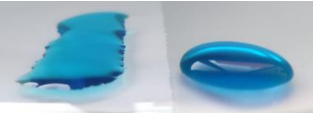
Resim 1: Sıvının; soldakinde kaplama yapılmayan yüzey üzerinde yayılışı ve sağdakinde hidrofobik kaplama yapılan yüzey üzerinde şeklini görüyoruz.
