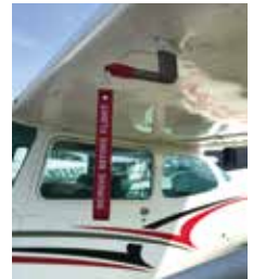
Şekil 2. Günümüzde uçaklarda kullanılan Pitot tüpü
