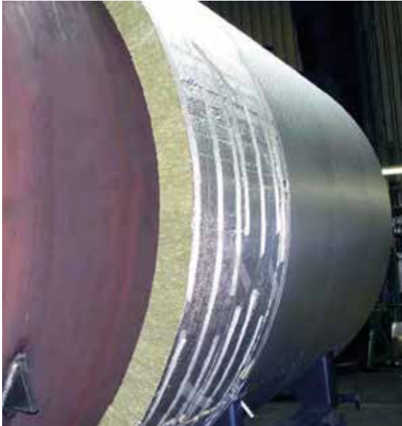
Şekil 1: Silindirik bölgede ara parçalar kullanılmadan kazanın yalıtılmasını gösteren fabrika fotoğrafı.
